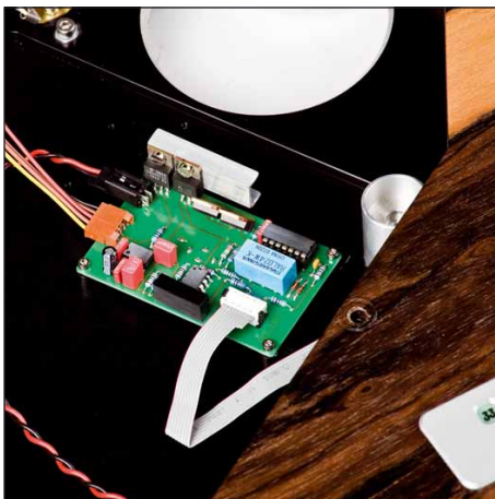
Die Platine beherbergt die Regelung für den Antriebsmotor
